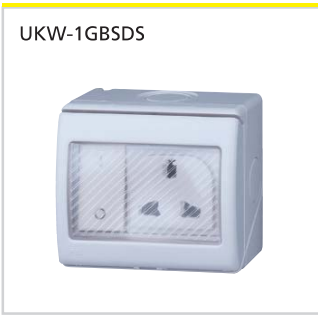
开关插座 Switch socket 15A-250V~ 表面安装 IP55 Surface mount
