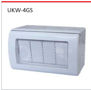
4联开关 4 Gang switch 13A-250V~ 表面安装 IP55 Surface mount
