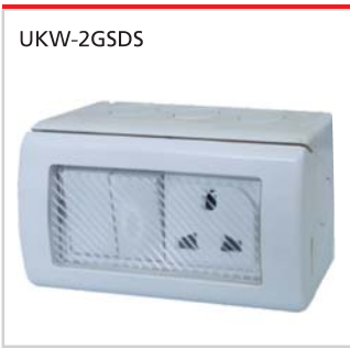
开关插座 Switch socket 15A-250V~ 表面安装 IP55 Surface mount
